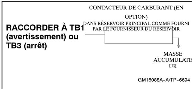
**Figure 6-9** Contacteur carburant bas (niveau ou pression)
