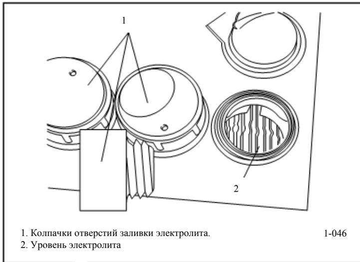
**Рисунок 3-8** Проверка уровня электролита
