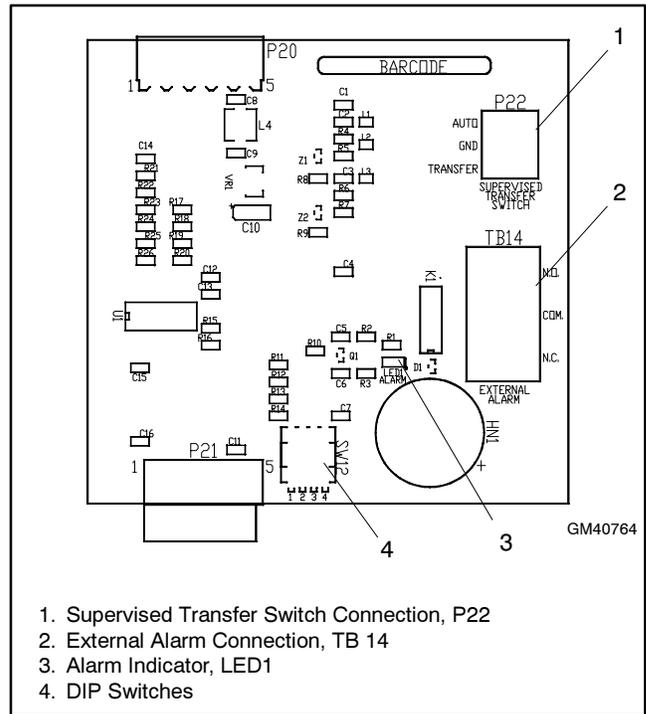
**Figure 8-12** Alarm Module
