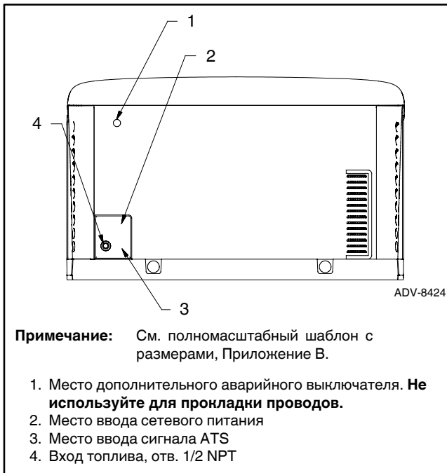
Рис. 1-16 Места входных отверстий для проводов
