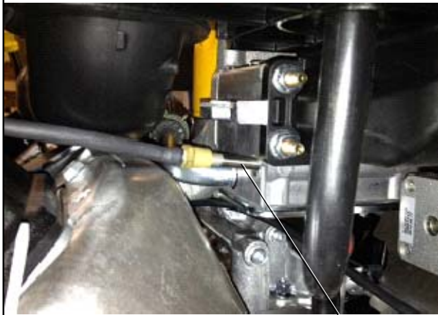
Рис. 1-42 Разъем питания 240 В для нагревателя карбюратора
