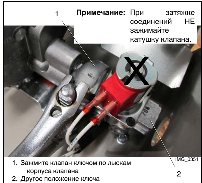
Рис. 1-8 Удержание топливного клапана при затяжке топливных соединений
