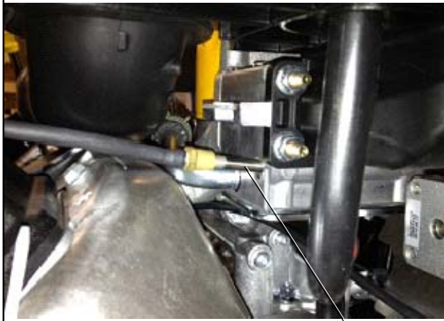
Figura 1-42 Conexión de alimentación de 240 voltios para calentadores de carburador
