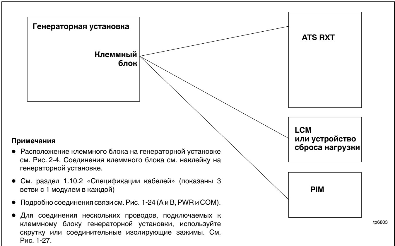
Рис. 1-26 Соединения вспомогательных модулей (3 кабельных ветви с 1 модулем каждая)
