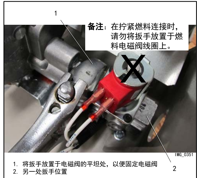
图 1-8 固定燃料电磁阀，以便拧紧燃料连接。
