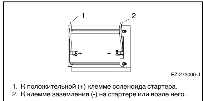
Рис. 5-10 Типовое подключение 12-вольтного аккумулятора системы с одним стартером
