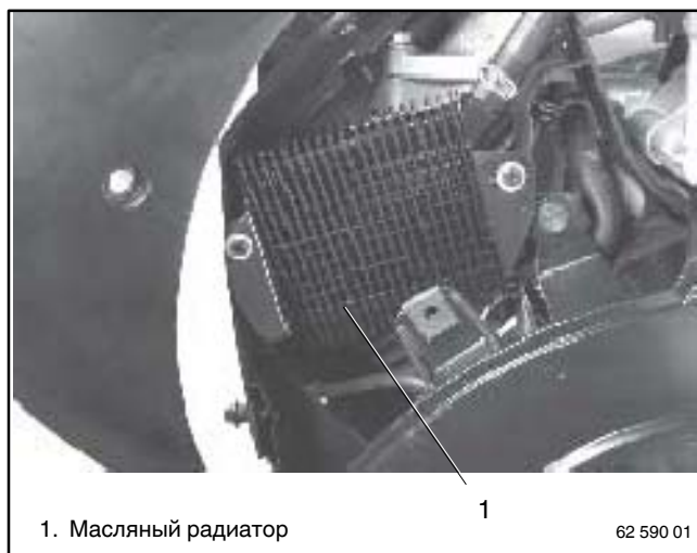
Рис. 5-3 Место установки масляного радиатора
