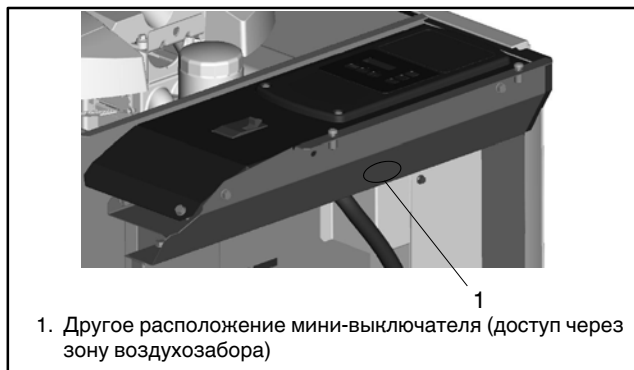
Рис. 6-3 Расположение вспомогательного мини-выключателя обмоток
