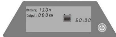
Le rétroéclairage s'éteint au bout de 10 secondes
