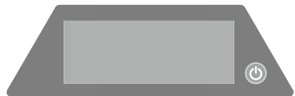
Figura 3 Apague el enCUBE1.8 (presione por 0.5 segundos)
